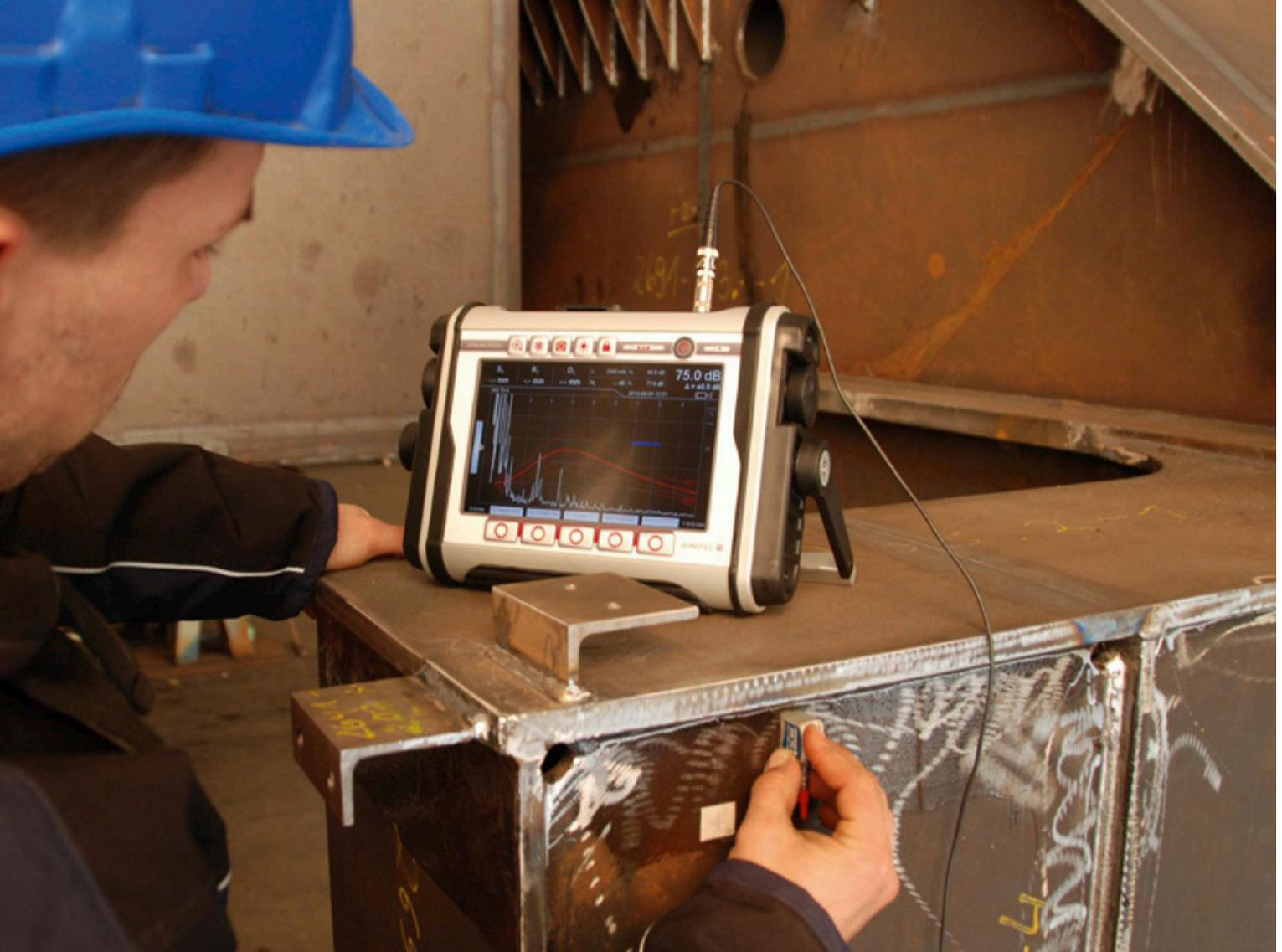
Kontrollmöglichkeiten in Bezug auf die Sicherheit ihres Produktes anzubieten. „Machbar“ bedeutet: Die Ultraschallmesstechnik muss „im Feld“ einsatzbereit sein; in der Werkhalle also wie auf der Baustelle. Ebenso an allen Rundungen, Ecken und Kanten des zu prüfenden Objektes. Und: Das Gerät muss für ein mittelständisches Unternehmen finanziell erschwinglich sein.
