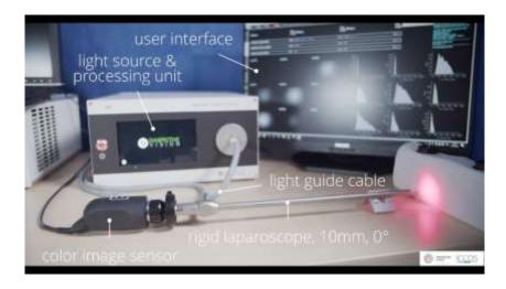
Im Rahmen dieser Arbeit sollen daher Labormessungen an Prüfkörpern und Proband:innen geplant, durchgeführt, protokolliert und analysiert werden. Zwei baugleiche MSI-Laparoskope sollen vermessen und verglichen werden. Teilaufgaben sind dabei:
